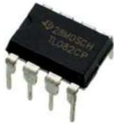
Un amplificador operacional, conocido como OP-AMP, es un dispositivo amplificador electrónico de alta ganancia acoplado en corriente continua que tiene dos entradas y una salida. En esta configuración, la salida del dispositivo es, generalmente, de cientos de miles de veces mayor que la diferencia de potencial entre sus entradas.
